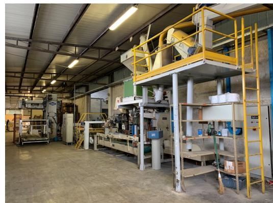
*Impianto completo Paglierani per confezionamento automatico sacchi con formato da 5 kg, 10 kg, 25 kg, include: unità di dosaggio e confezionamento Paglierani modello G 358 matr. 493-88; unità di pesatura elettronica Paglierani matr. 88323 celle n' 128-129/1988; unità di chiusura e movimentazione sacco; nastro trasportatore sacchi con spandine laterali ; quadro elettrico generale, pallettizzatore completo Coman anno 1992*
